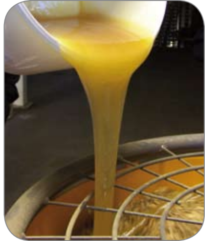
Pour the mixed resin into the mixer
